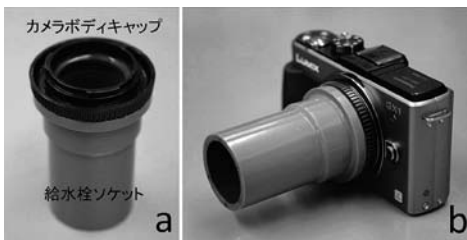
図5. 自作の顕微鏡-カメラアダプター。 a: アダプターの構成(カメラボディキャップと給水栓ソケットは両面テープで接着した)。b: カメラに取り付けた状態。
