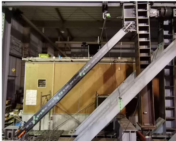
(b) 試験体T-2 ( R=-3\% 圧縮側)
