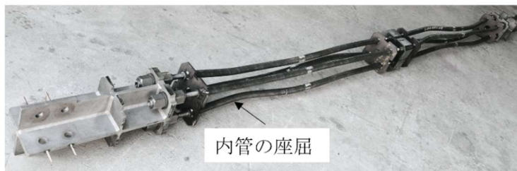
(c) 試験体 T-3 (実験終了後)
