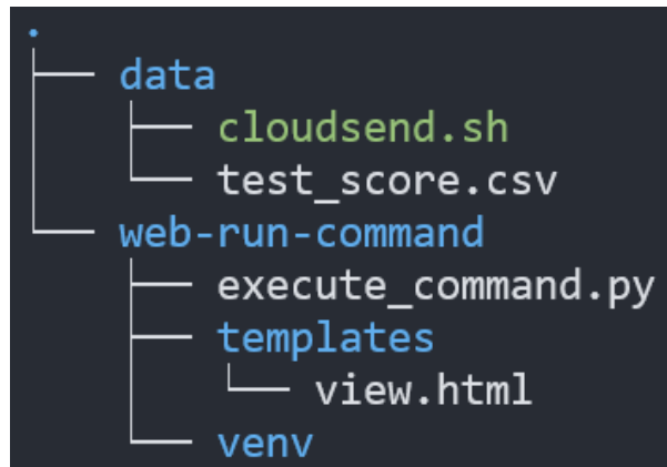
図 29 処理サーバのディレクトリ構成
