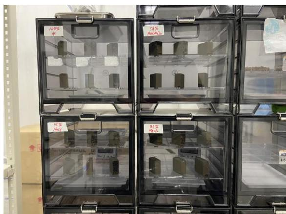
図 4- 77 平衡含水率測定の様子
