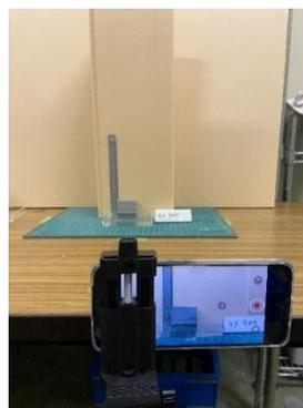
図4-95 吸水時間の計測
