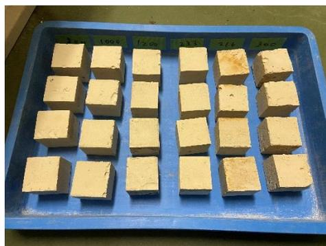
図 4- 109 圧縮強度試験に用いた試料
