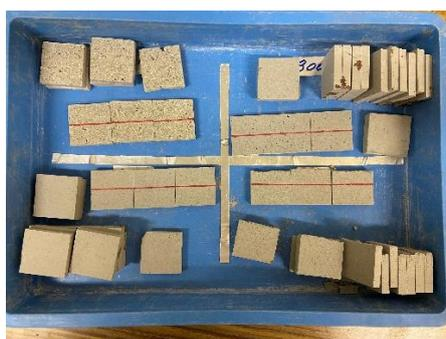
図4-96 吸水速度試験に使用した試料
