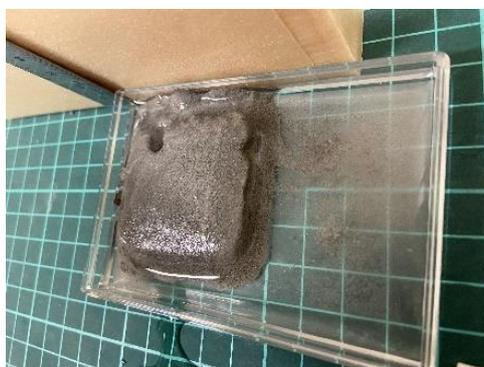
図 4- 107 吸水量試験でのセッコウ系試料の様子
