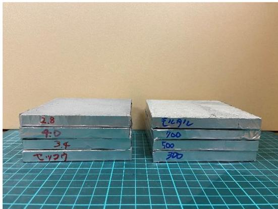
図 4- 1 吸放湿試験で使用した試料の一部
