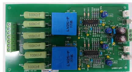
図 5.5 電圧センサ外観図
