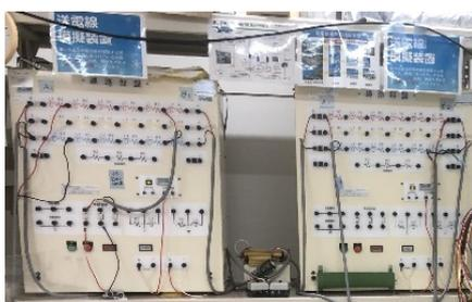
図 5.14 模擬送電盤の外観図
