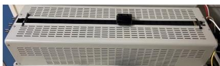
図 5. 19 可変抵抗器の外観図
