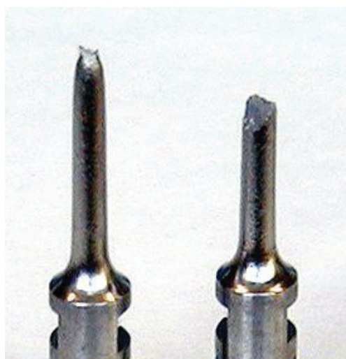
Fig.1-5 SUS316 オーステナイト系ステンレス鋼の水素環境脆化の外観 21) (左 : 70MPa アルゴン中破断, 右 : 70MPa 水素中破断)
