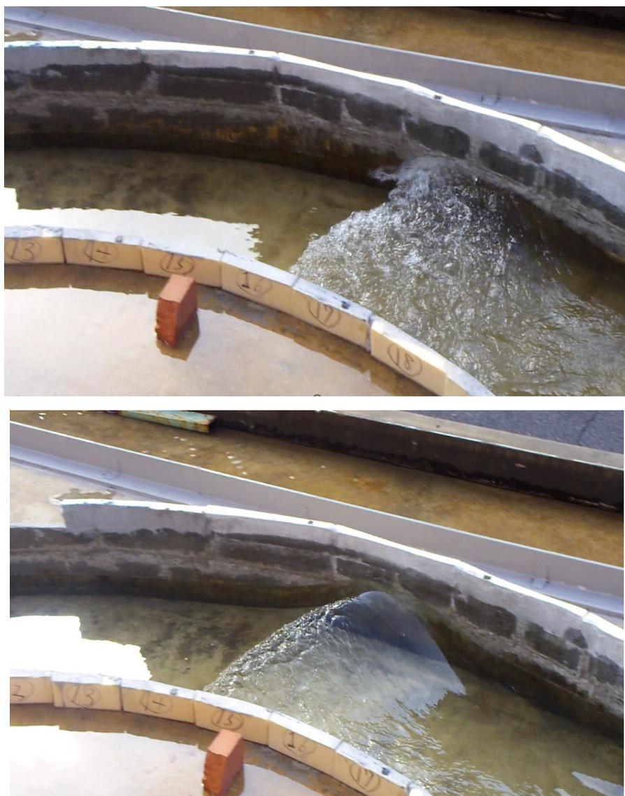
図 1-2 蛇行水路を伝播する碎破段波（上）と波状段波（下）
