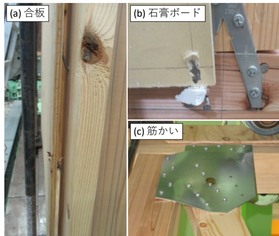
(a)釘の曲げ及び抜け出し、(b)パンチングアウト、(c)金物の変形 写真 4.2 各試験体の破壊性状
