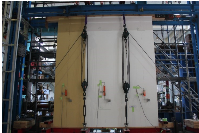
写真 2.1 筋かい耐力壁試験体の設置状況
