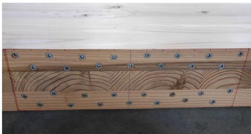
写真 5.3-2 載荷面のめりこみ補強
