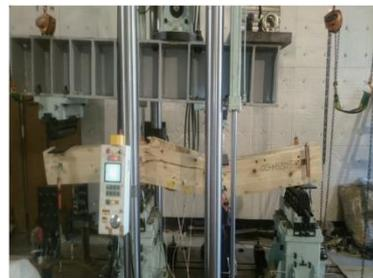
写真 1.1-2 既往文献<sup>1-19)</sup>における曲げ破壊
