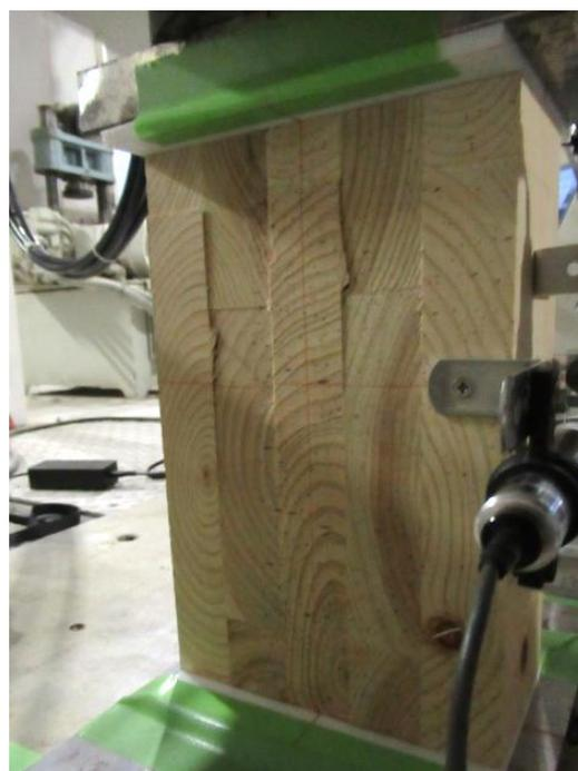
写真 2.5-14 Off-axis 法の破壊性状 30°
