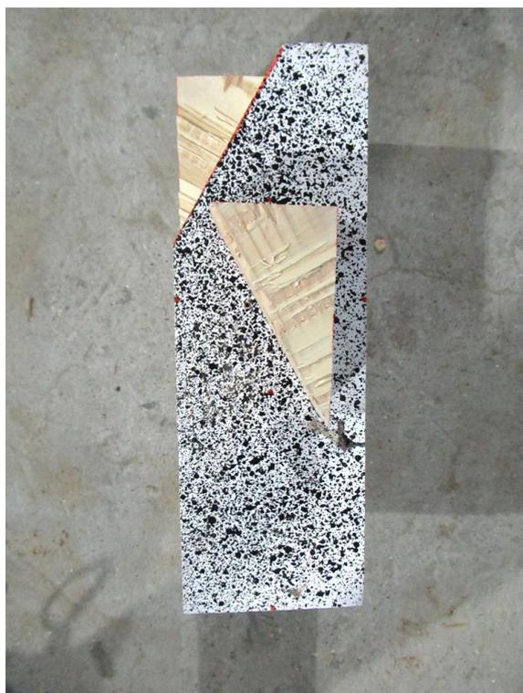
写真 3.4-7 接着層の剥離
