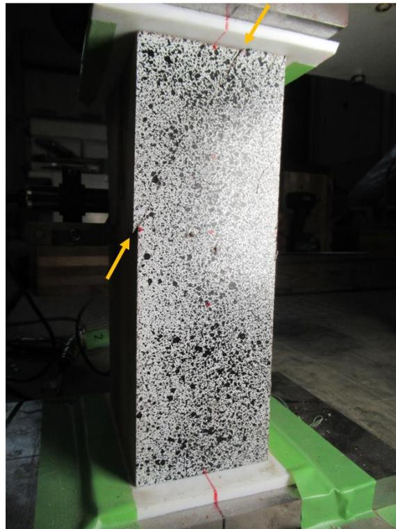
写真 3.4-6 Off-axis 法のせん断破壊 30°
