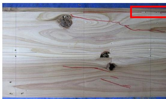
写真 3.4-9 計測のビス位置不良
