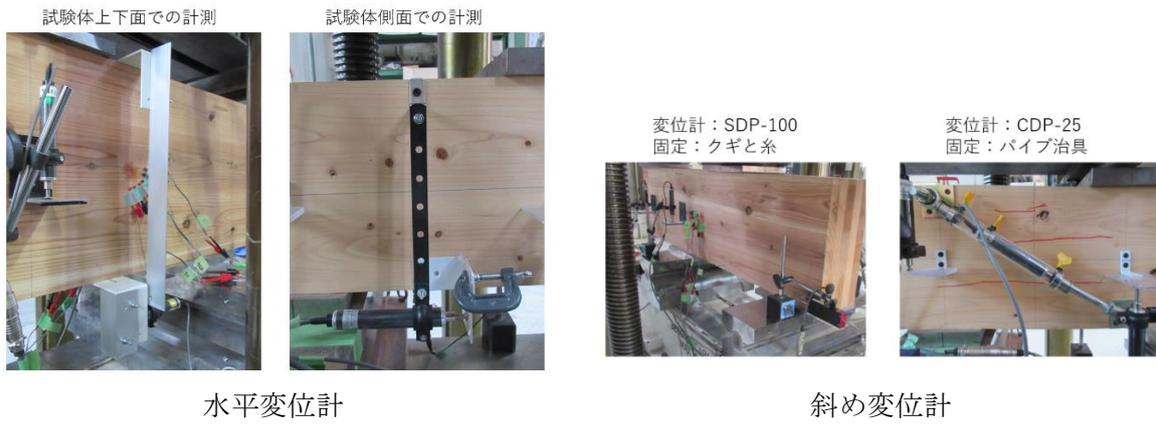
図 2.4-3 計測方法の相違点（左：スギ試験体、右：ヒノキ試験体）
