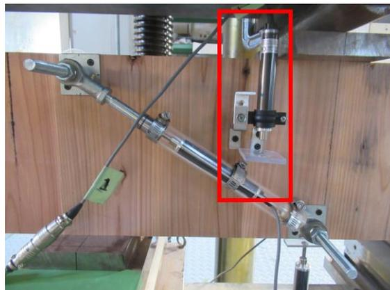
写真 4.3-6 ラミナ境界での計測（弱軸）
