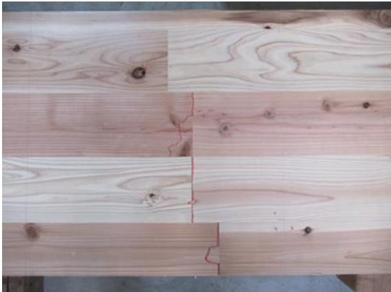
写真 5.3-5 載荷点下部の曲げ破壊 (500mm)
