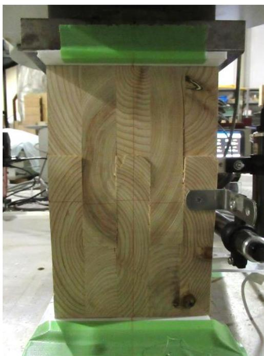
写真 2.5-13 Off-axis 法の破壊性状 45°
