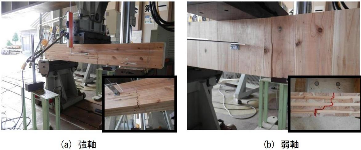
図 5.3-1 文献<sup>5-7)</sup>での曲げ破壊
