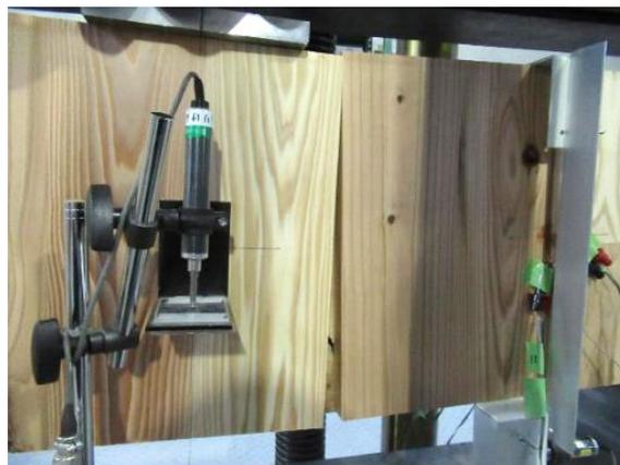
写真 2.5-6 弱軸試験体の曲げ破壊
