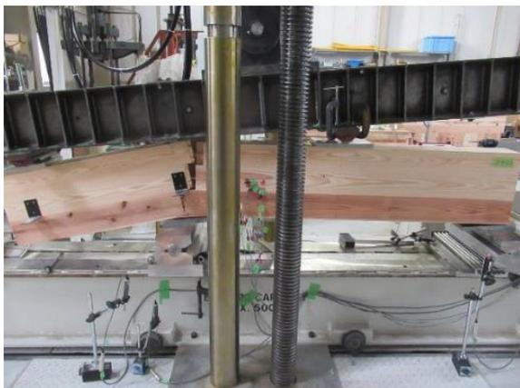
写真 2.5-5 強軸試験体の曲げ破壊
