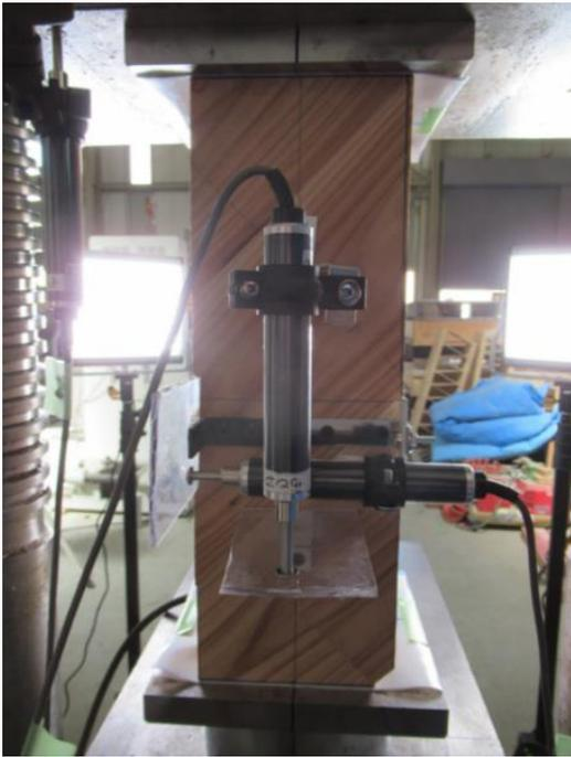
写真 2.4-2 変位計での計測
