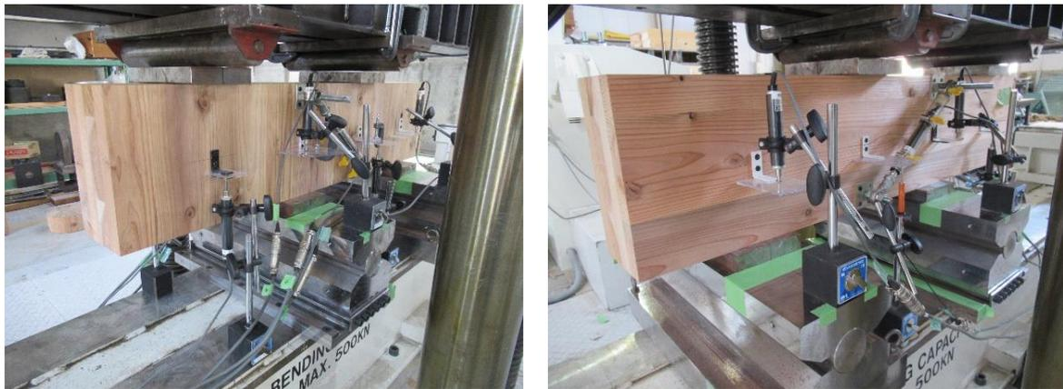
斜め変位又は水平変位を片面ずつ計測
