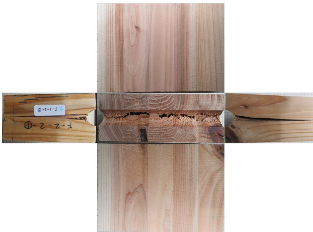
写真 4.7 集成材試験体の破壊性状
