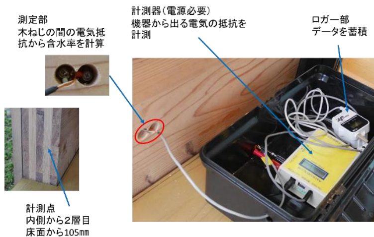
図 1.4 含水率計測方法
