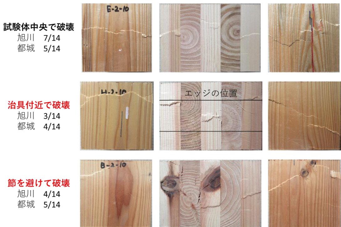
写真 4.2 全面圧縮試験の破壊性状（半年暴露試験体）
