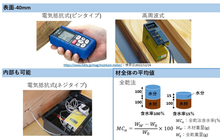
図 2.1 木材の含水率計測方法とその計測範囲
