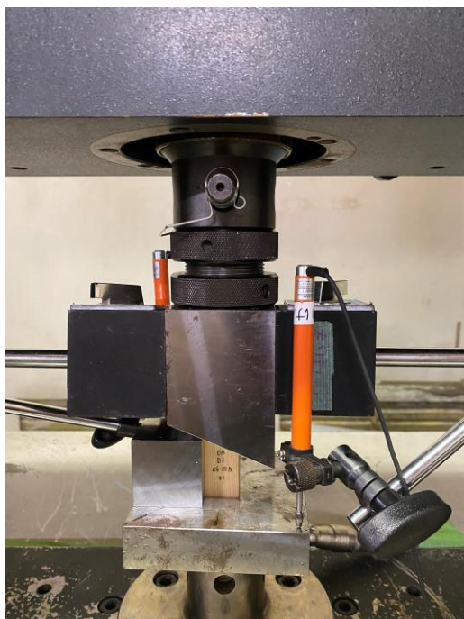
写真 3.3-1 傾斜加力面での実験の様子
