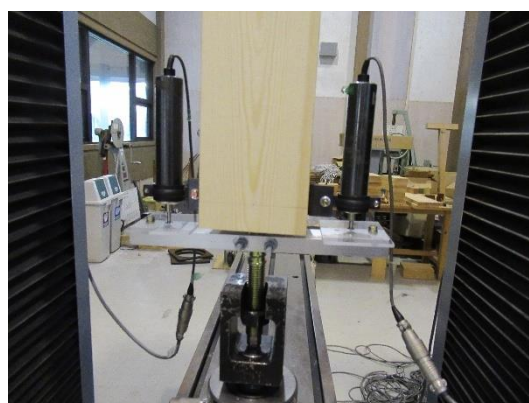
(ii) L=250・300 の変位計設置の様子
