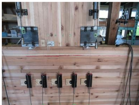
柱材側せん断金物ビス底部付近の横引張割れ 写真 6. 4. 1-2 破壊性状
