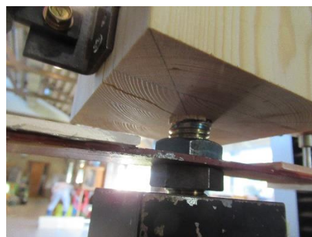
写真 2.4.1-2 オウシュウアカマツ ：割裂破壊
