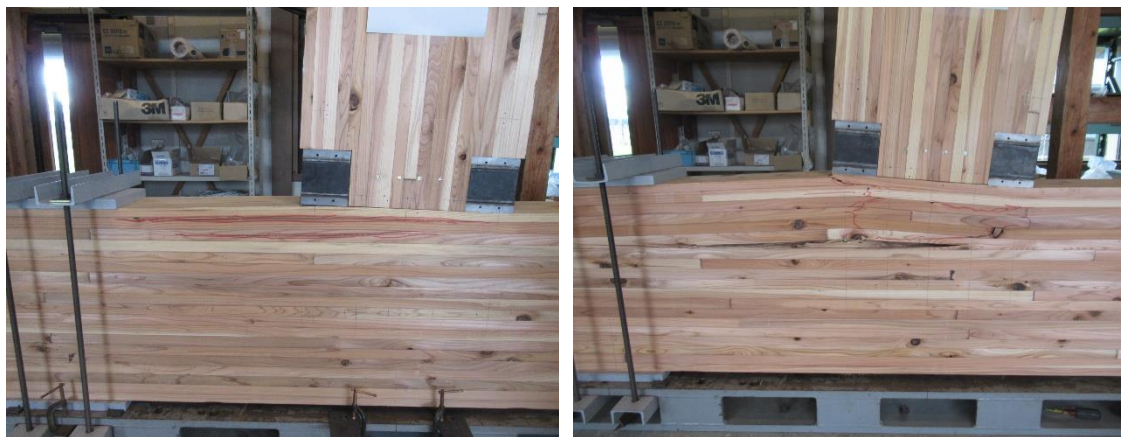
柱材側せん断金物ビス底部付近の 横引張割れ
