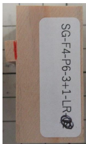
(3) LSB 形状 : b=3+1 せん断面の横引張破壊
