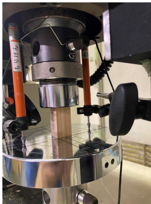
写真 3.3-2 縦圧縮試験の様子
