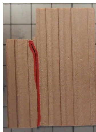
(4) JIS 形状 せん断面のせん断破壊
