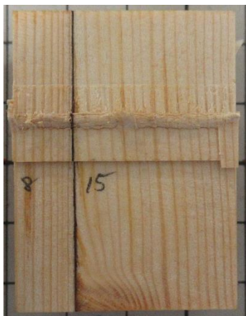
(1) LSB 形状 : b=1 加力面の圧縮めり込み
