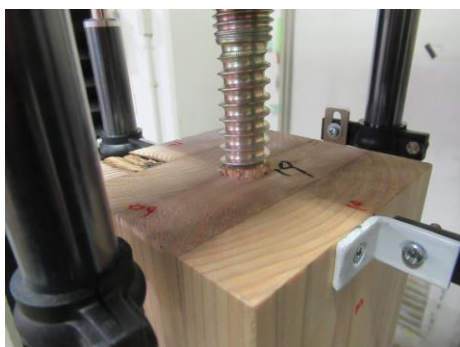
写真 2.4.1-1 スギ：引き抜け破壊
