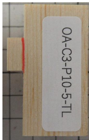
(2) LSB 形状 : b=3 \cdot 5 せん断面のせん断破壊
