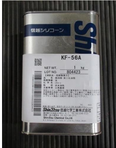
図 2.5 実験に用いたシリコンオイル (KF-56A)
