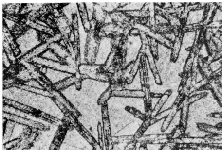
写真 17 矢野勝光山 滝の谷 平行ニコル ダイアスポアの柱状結晶、周囲は パイロフィライト
