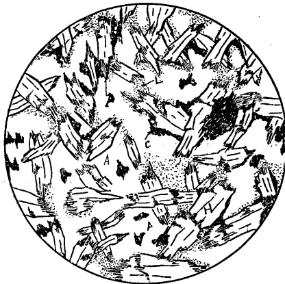
Fig 3. 角閃石輝緑岩起源の結晶片石 H : 角閃石 (レクタ) 組織 : 短冊状構造 (レクタ) C : 緑泥石 P : パンペリー石 (一部陽起石) L : 白チタン石 A : 曹長石
