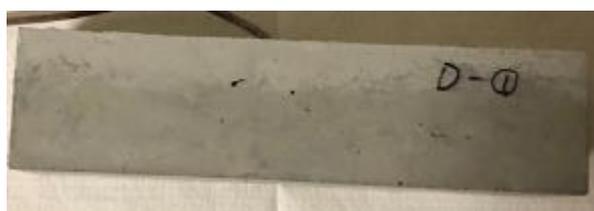
写真 2.4-1 粗骨材を使用した試験体の表面ひび割れ
