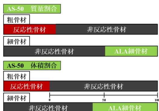
図 3-10 ALA 試験体調合概要 (AS)
