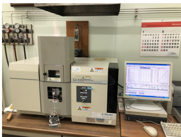
図 4-4 原子吸光光度計
