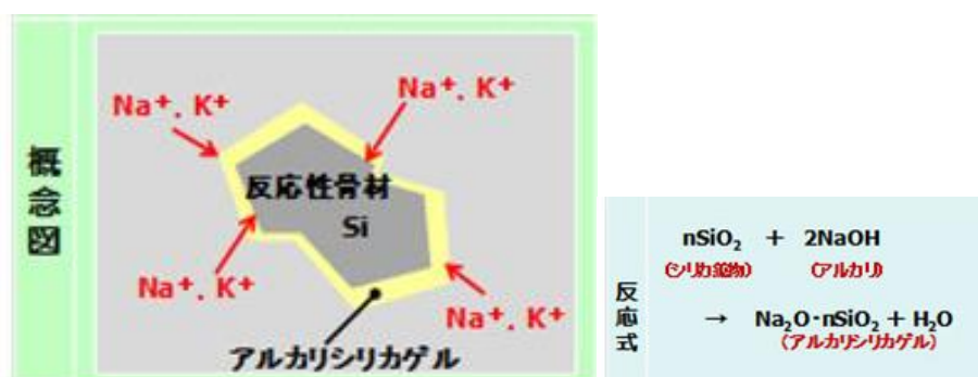
図 4-1 ASR 発生の概念図 1)
