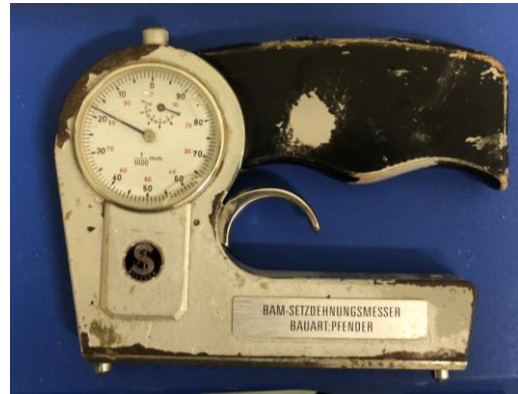
図 3-17 コンタクトゲージの写真
