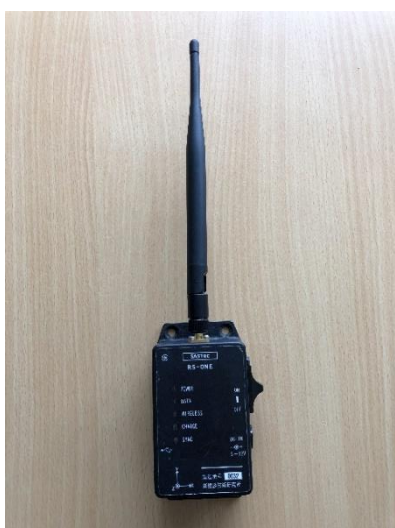
図 2-1 無線加速度センサの概要
