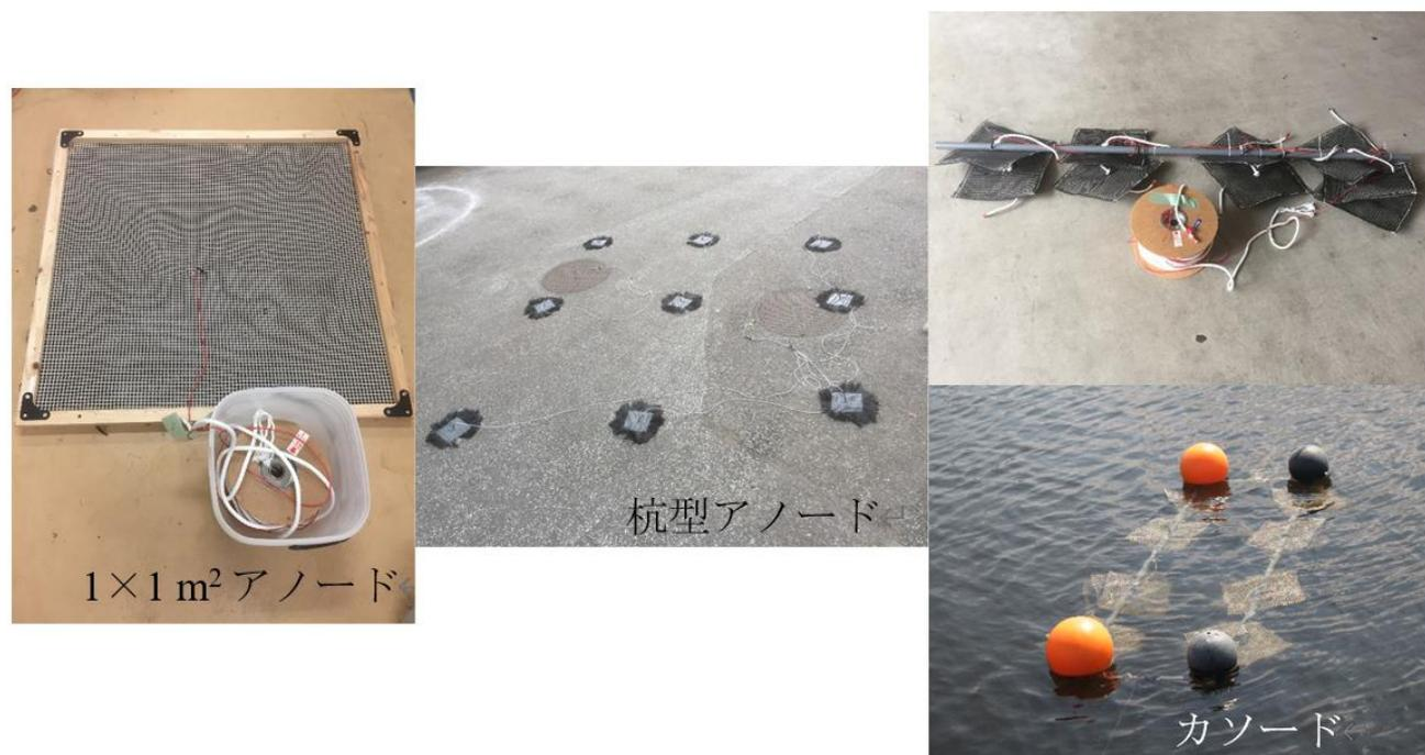
図 4-22 電極サイズ、複数接続による SMFC 性能評価実験の様子および概略図
