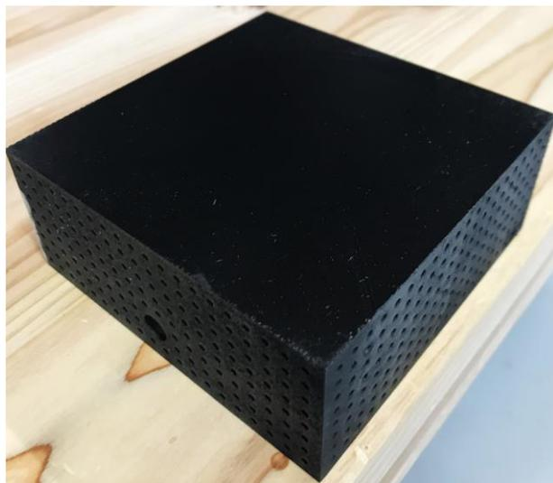
図 6.3 金属付加製造による造形体の外形（黒体塗料塗布後）
