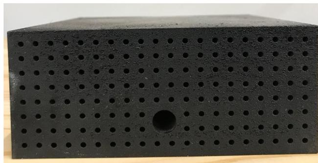
図 6.4 金属付加製造による造形体の側面（黒体塗料塗布後）
