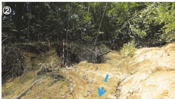
図-2.3 平成 30 年 7 月豪雨災害の表層崩壊・土石流発生事例（広島県東広島市西条町下見，上段：対象溪流周辺広域，中段左：流域全景，中段右①：崩壊源頭直上部（勾配 12°），下段左②：崩壊源頭部（勾配 17°），下段右③：土石流流下区間（勾配 20°））【対象流域周辺広域・流域全景：H30.7.14 撮影（国土地理院垂直写真（電子国土 Web）を加工して作成），その他：R1.7.25 撮影】
