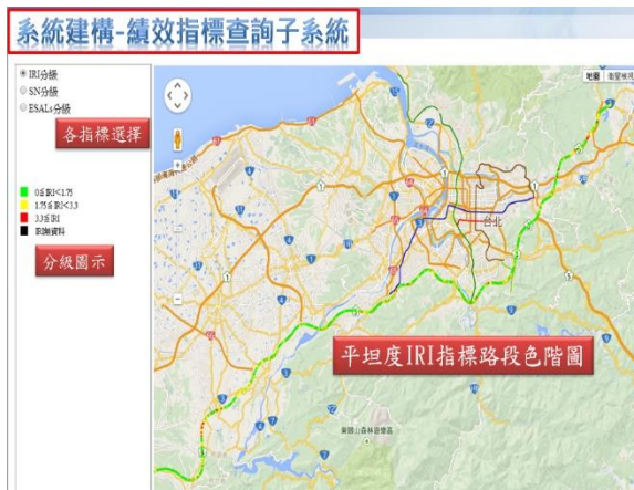
Fig. 7-10 Pavement Index Color Codes
