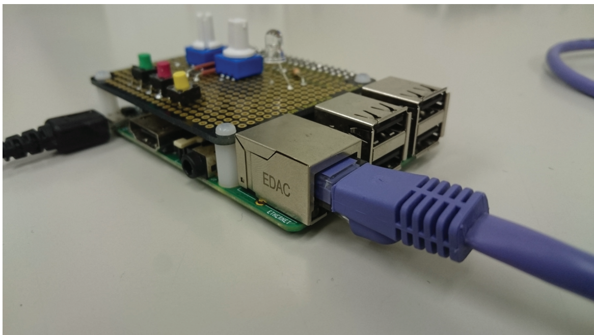
図 3.9 端末教材の LAN ケーブル接続
