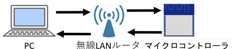
図 4.2: PC とマイクロコントローラ間の通信形態
