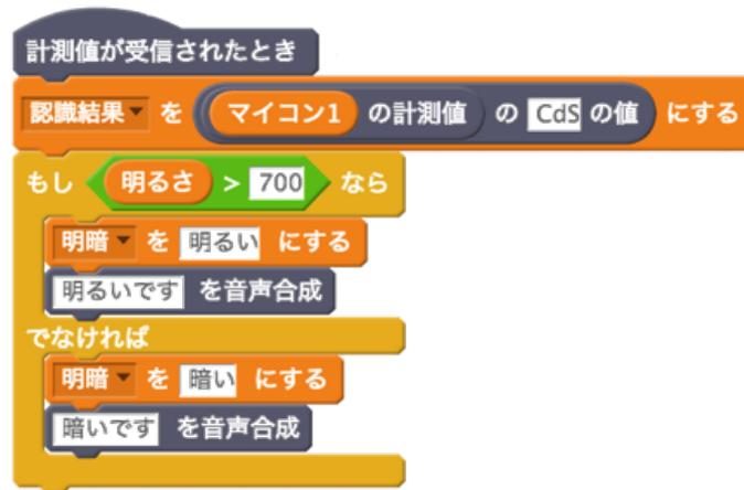
図 5.16: 音声合成を追加した Scratch スクリプト
