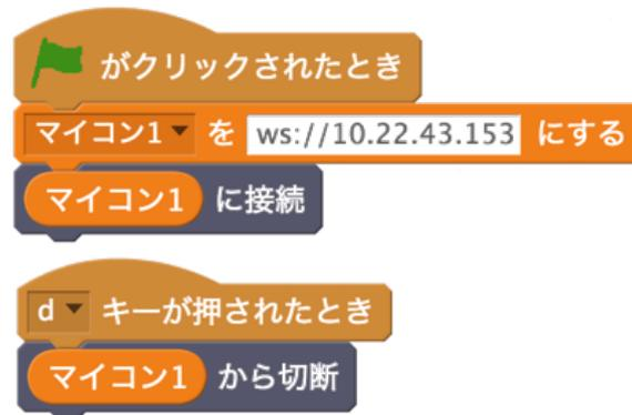
図 4.15: マイクロコントローラへの接続と接続を切断する Scratch スクリプト
