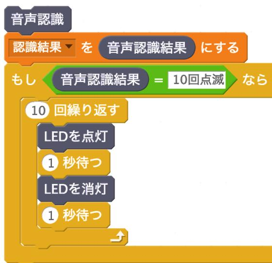
図 5.15: 音声認識の結果を利用して LED を点滅制御する Scratch スクリプト
