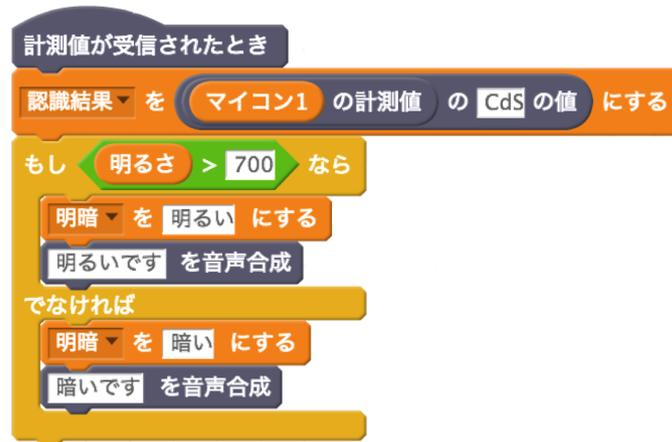
図 4.18: 計測値を取得して明暗を判断する Scratch スクリプト
