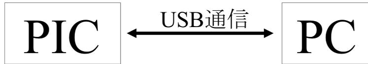
図 5.4: USB による PC とマイクロコントローラ間の有線通信
