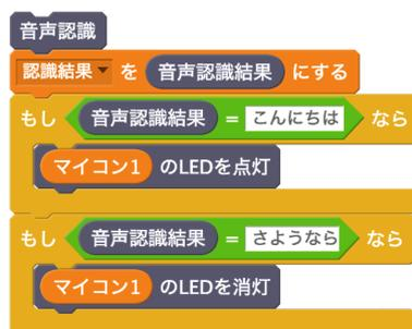
図 1: 音声認識の結果を利用して LED を制御する Scratch スクリプト
