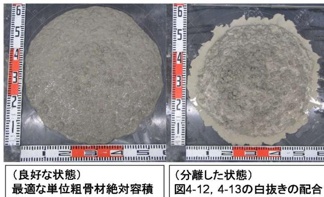
写真 4-2 スランプフローの状態の比較例
