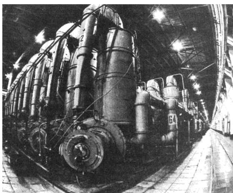
Fig.2. The Soviet-made gas-diffusion apparatus, OK (Velikhov, 164)
