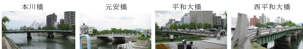
測定方法は、①、巻き尺を橋端から川面に垂らして距離を測定する。②、巻き尺を橋端から橋桁の下端まで垂らして距離を測定する。③、①の値から②の値を引く。④、③で得た値に別に計算したその地点のその時刻の川面の標高（T.P.値）を加えて測定地点の橋桁の下端の標高（T.P.値）を得た。一つの橋で3か所を測定した。即ち、橋の東と西の端から中央向きに10mのところと橋の中央の3か所である。上記のような方法であるから誤差があるが、目的からすると誤差は小さいので、表9に5橋の測定結果を示す。
