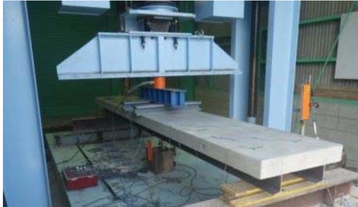
図-5.6 載荷試験状況
