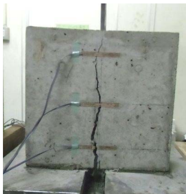
図-3.11 PBL 破壊時のかぶりコンクリートのひび割れ
