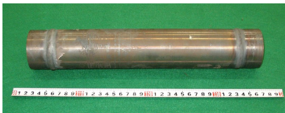
図2-2 内圧クリープ試験体の外観
