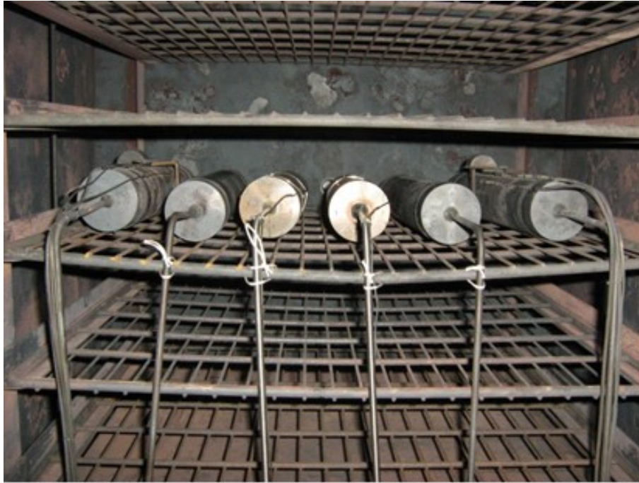
図2-3 電気炉内における内圧クリープ試験体の設置状況
