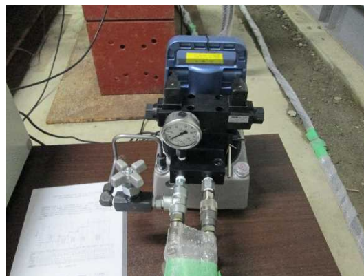
写真 3.11 電動油圧ポンプ
