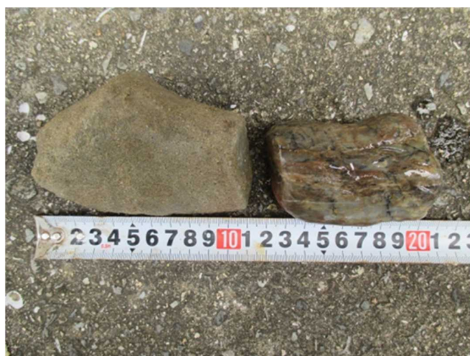
写真3.4 孔内洗浄時に確認された洪積礫質土層の砂岩・チャート礫
