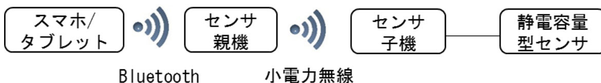
図 5.3 予備実験に用いた濡れ計測システム（既報で開発 5) ）
