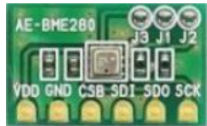
写真 5.8 温度・湿度・気圧センサ (寸法: 10×11mm)
