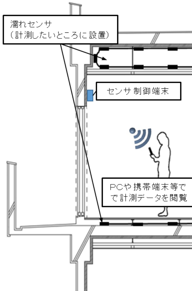
図5.2 住宅におけるセンサ設置および計測のイメージ
