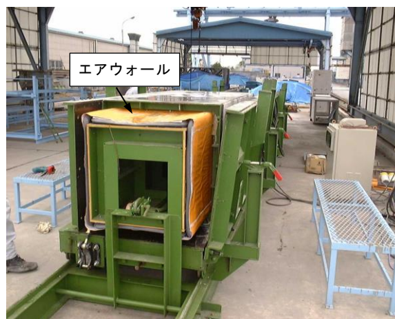
写真 4.3 エアウォールの空気抜き
