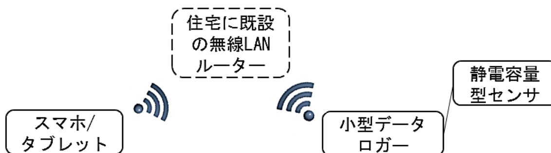
図 5.17 開発した濡れ計測システム 9)
