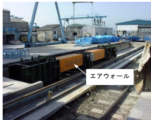
図 4.2 システム型枠の概要
