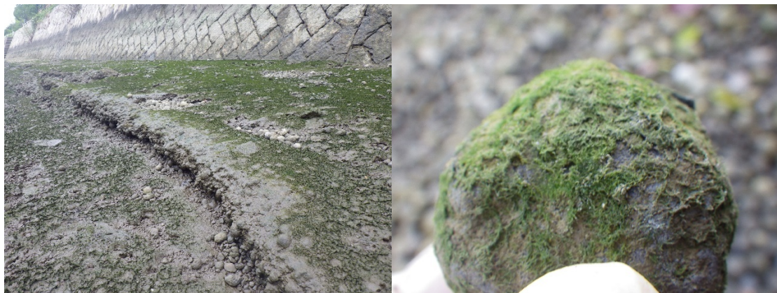
写真-1 石炭灰造粒物施工区に繁茂する藻類 (H27年8月No.3撮影)
