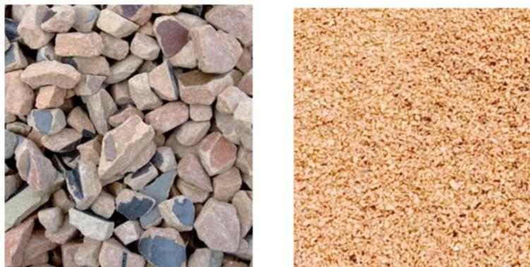
写真 3.1 廃瓦骨材（左：粗骨材，右：細骨材）
