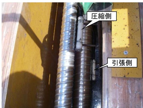
写真 4.3 PC はり部材の埋設ひずみ計
