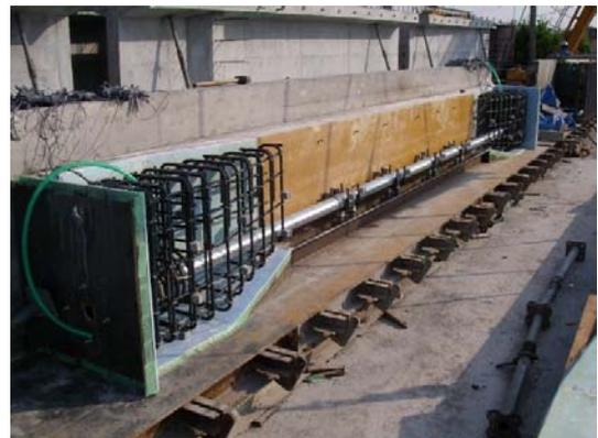
写真 4.1 PC はり部材の配筋と外観
