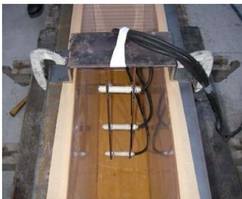
写真 4.2 無拘束供試体の埋設ひずみ計
