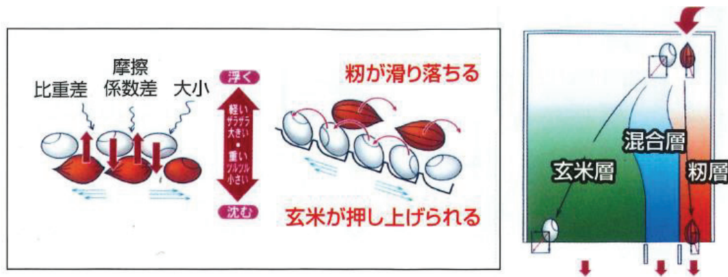
図 3-16 揺動選別の仕組み
