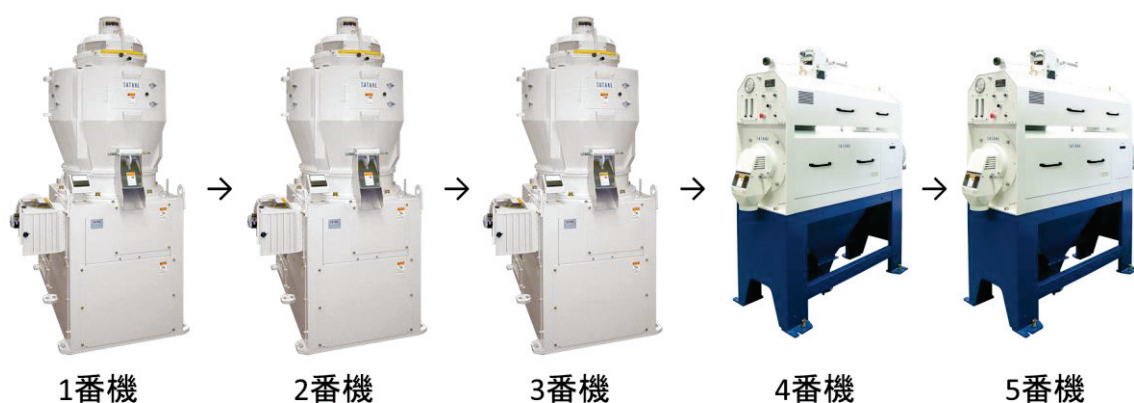
図 3-21 長粒種の精米ライン（研削式精米機 3 台＋湿式研米機 2 台）
