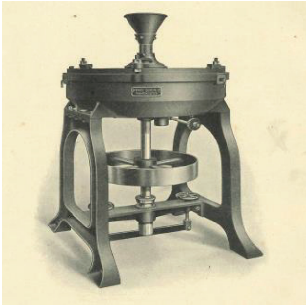
図 3-9 独立型シェラー式脱ぶ機
