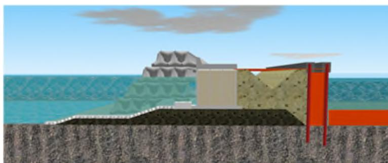
図-8.8 側面遮水壁の構築と底面遮水の施工
