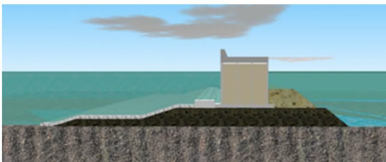
図-8.5 重力式護岸（建設中は防波堤の機能を有する）の施工
