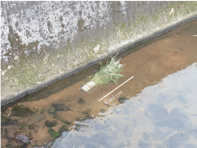
図3 河道内に設置した柴漬けトラップ
