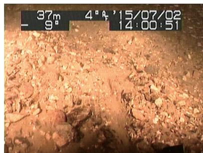
Fig. 3 ドレージ調査で礫成分を中央粒径とした水底が確認された高根島西沖 St-8 (海砂利採取区域内；Fig. 1) の水中景観。水中テレビカメラ装置 (RTV-100MK II S) により撮影。
