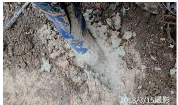
写真6 山王谷川砂防堰堤右岸側付近の崩壊地で見られた白色に近い粘土
