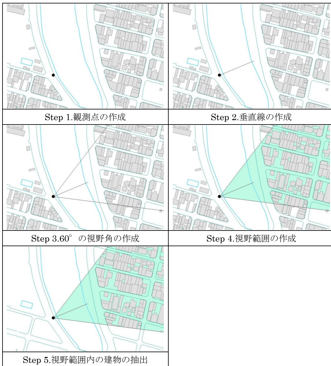
図 3-8 見通しエリア作成手順 (Arc map 上での作業)
