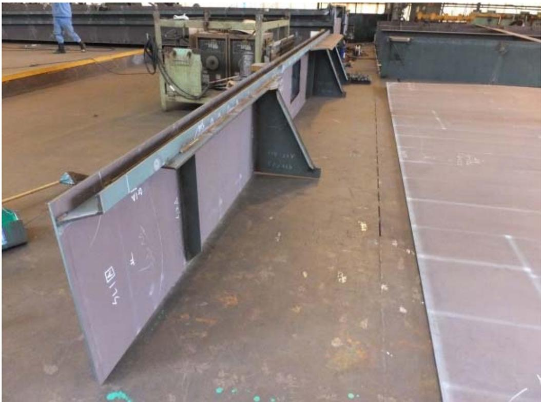
Fig. 4-25 仮組み溶接の状況
