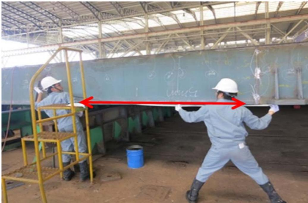
Fig. 2-6 既存の三次元計測状況
