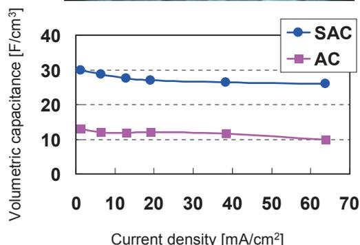
**EDLC volumetric capacitance**
