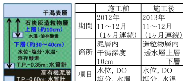
図-4.3.8 水質計設置・測定概要 8)
