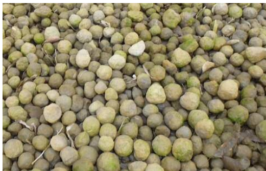
写真-4.3.3 石炭灰造粒物の敷設状況（藻類の付着状況） 8)
