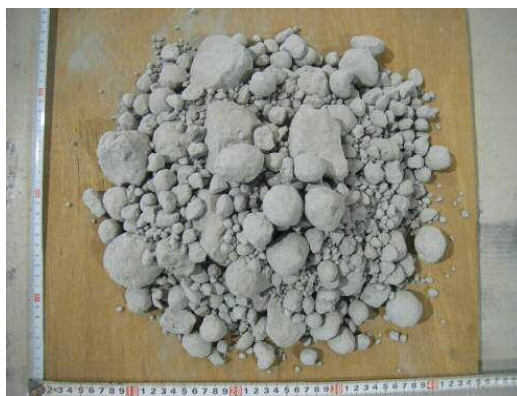
図-6.1.1 石炭灰造粒物 2)
