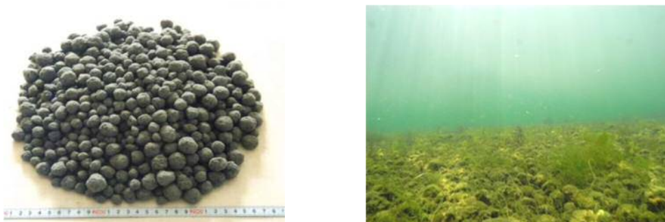
写真-7.1.1 石炭灰造粒物の外観および実海域への覆砂状況
