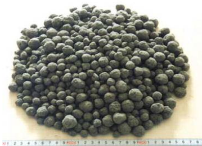
写真-1.2.1 石炭灰造粒物（Hi ビーズ／中国電力） 6)
