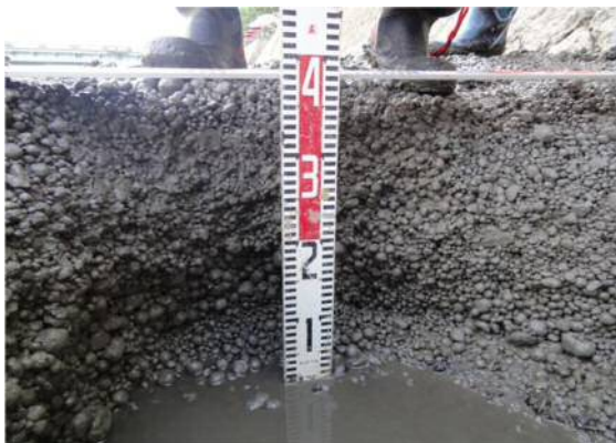
写真-3.4.1 石炭灰造粒物層の断面写真 14)
