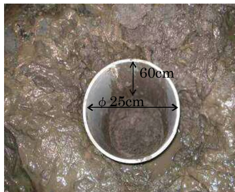
写真-4.2.3 コアパイプによる地下水流動状況確認 7)
