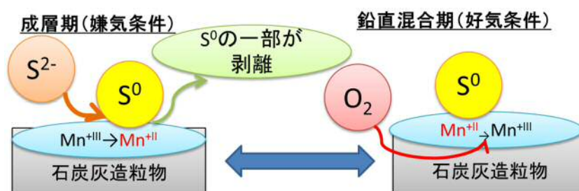
図-3.6.2 石炭灰造粒物の硫化物イオン吸着サイト再生機構 23)
