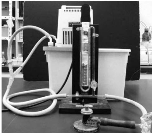
図1. 水流アスピレーターを用いた水の飽和蒸気圧の測定装置の写真。水流アスピレーターの水温が17℃のとき、水の飽和蒸気圧は16 mmHgであることを示している。
