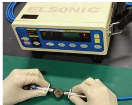
写真-4.2 粗骨材の超音波伝播時間の計測状況
