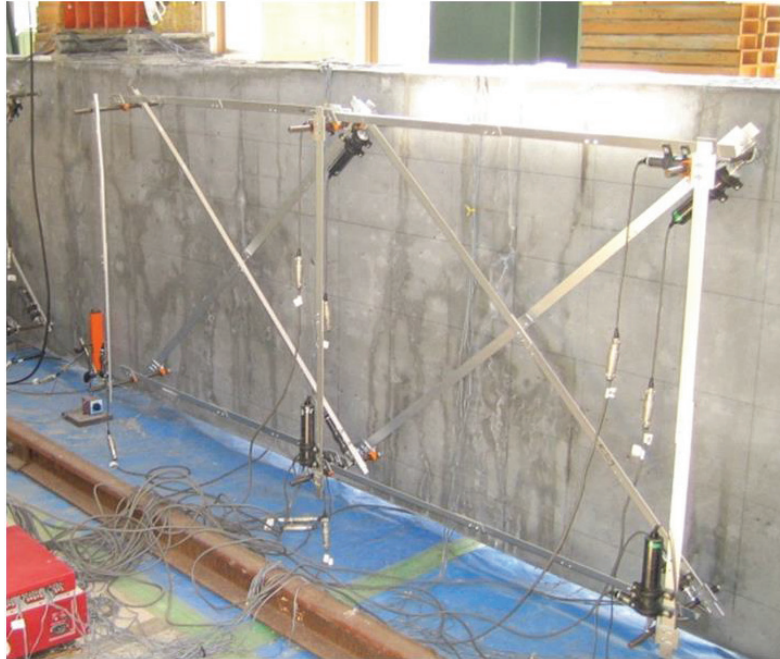
写真-6.2 せん断スパン内の変位の計測状況
