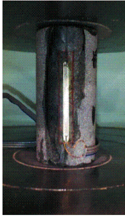
写真-4.1 粗骨材コアの載荷試験状況
