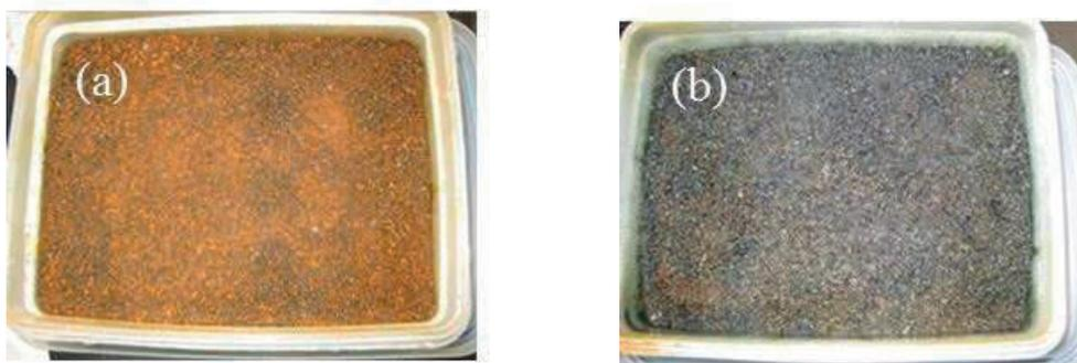
図 3-11 海水通水停止時(a)及び還元条件に浸漬 1 日後の脱リンスラグの表面写真(b)
