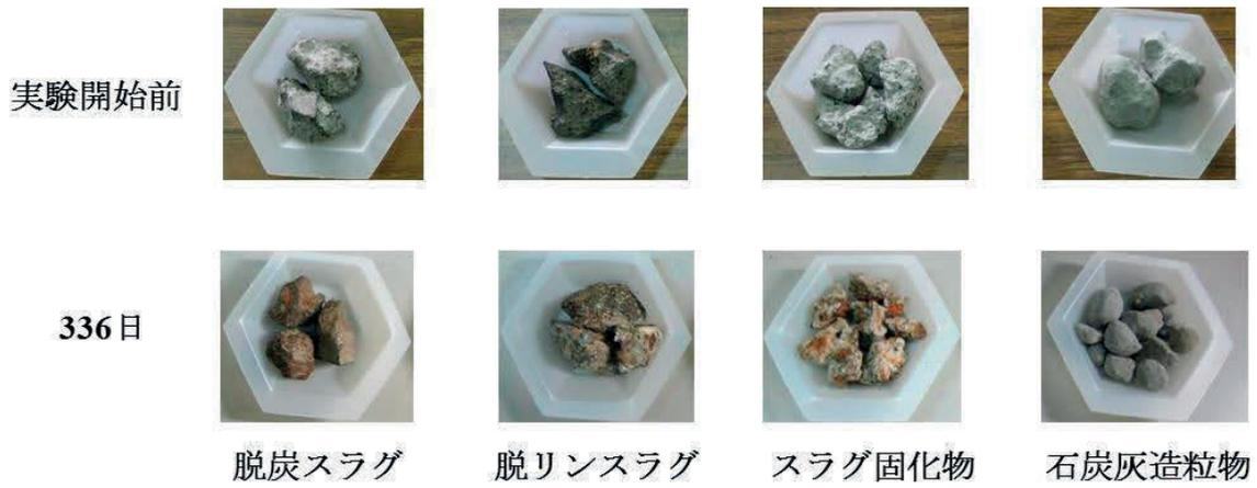
図 2-5 実験開始前, 及び実験開始 336 日後の脱炭スラグ, 脱リンスラグ, スラグ固化物, 石炭灰造粒物の写真
