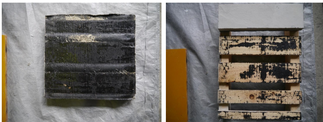
写真 5.7 引張試験後の試験体 (C3 防水紙 : BS1, 左 : モルタル, 右 : ラス下地板)
