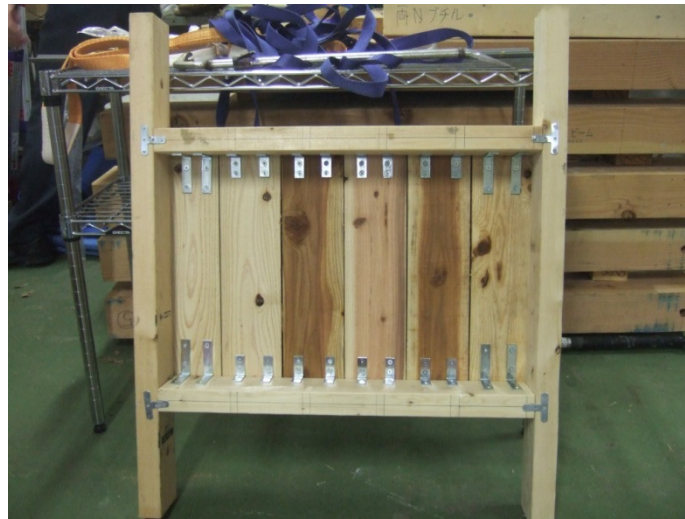
写真 5.5 下地の接合状況
