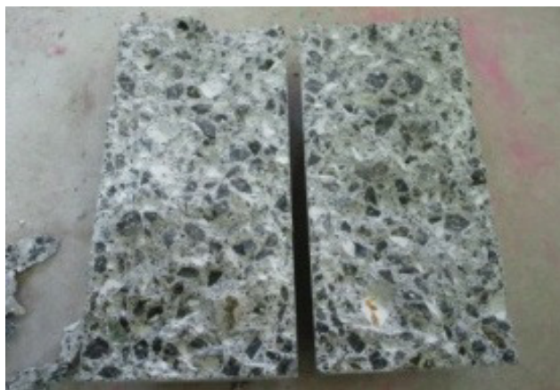
写真 3.1 割裂した円柱供試体
