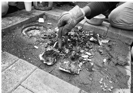
写真8 含鉄生成物磁選状況 (1回目実験)
