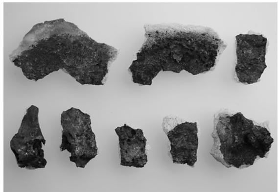
写真16 炉壁内面熔損状況（2回目実験）
