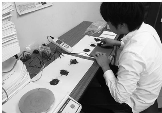
写真12 含鉄生成物形状計測作業
