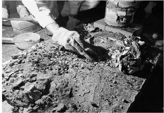
写真10 含鉄生成物磁選状況（2回目実験）
