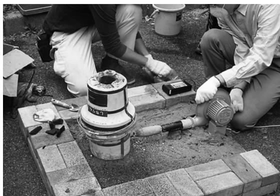
写真4 炉内温度調整作業
