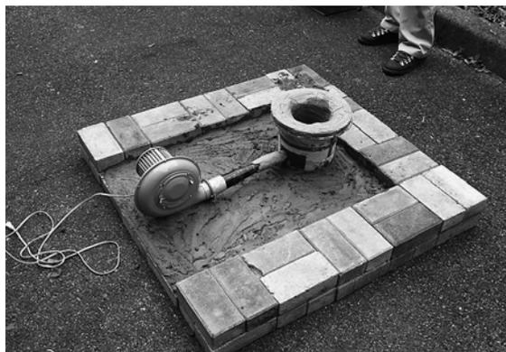
写真2 炉および送風管設置状況
