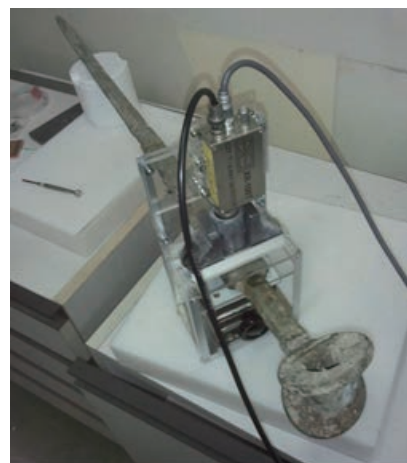
第 7 図 蛍光 X 線分析装置と写真
