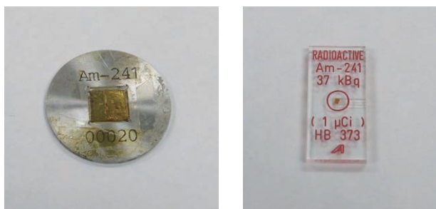
第 8 図 電着型 241 Am アルファ線源（左）と 241 Am ガンマ線源（右）
