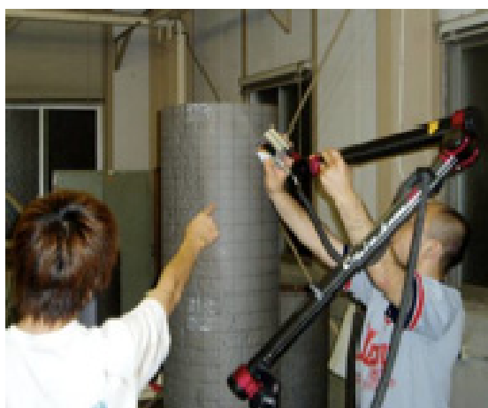
写真-5.2 表面座標計測の状況
