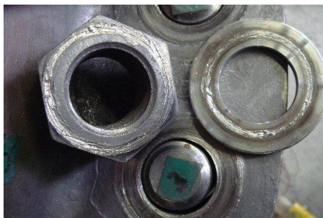
Fig.5-15 ボルト締付け実験後のナット座面状況
