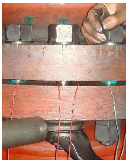
Fig. 5-14 ボルト供回り防止用ダブルナット
